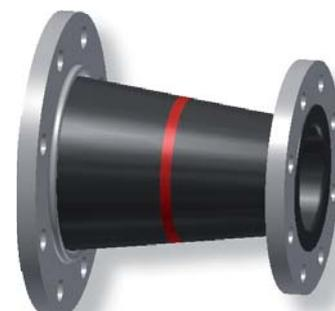
**Conception du soufflet** Soufflet en élastomère lisse, conique ou excentrique avec carcasse et collet d'étanchéité moulé avec un anneau de renfort auto-étanche (aucun joint supplémentaire requis). Equipé de brides tournantes.
