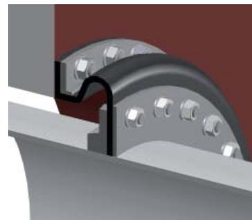
**Conception du soufflet** Soufflet en élastomère avec carcasse, avec ou sans forme d'onde. Une connexion au choix, soit avec manchons cylindriques pour une fixation par colliers de serrage, soit par brides pleines en élastomère, soit une combinaison des deux. Les versions à brides sont adaptées pour l'emploi de contre brides.
